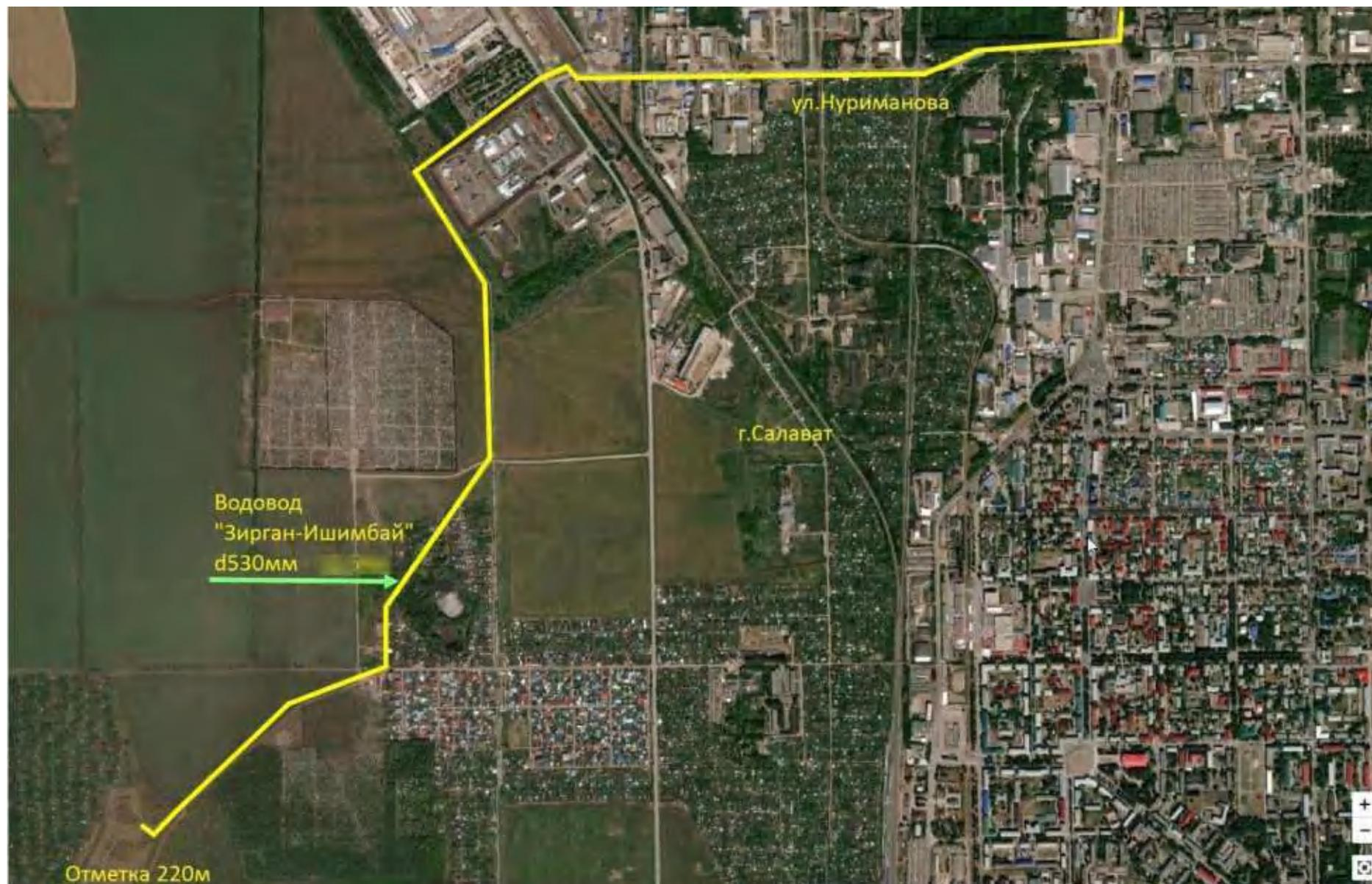
Рисунок 1.4.2.5 – Участок водовода «Зирган-Ишимбай» под капитальный ремонт методом санации
