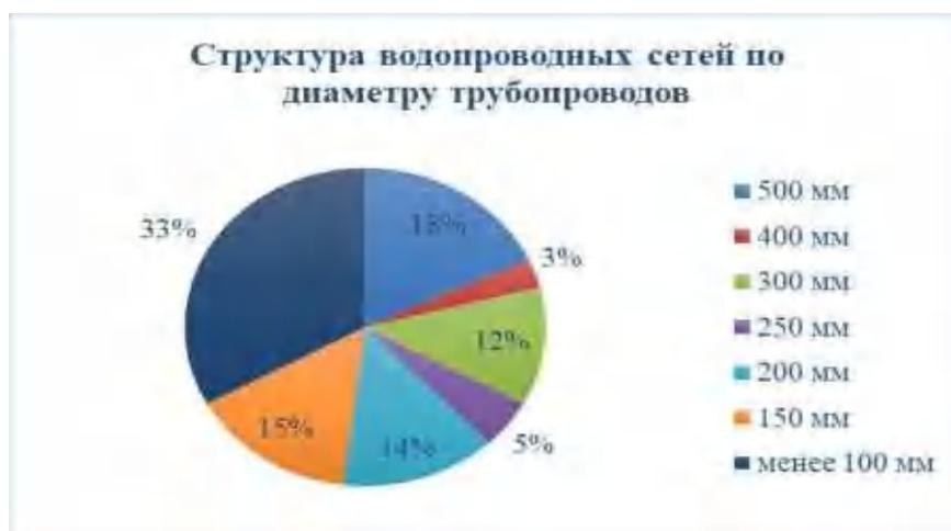
Рисунок 1.1.4.6 – Структура водопроводных сетей по диаметру трубопроводов
