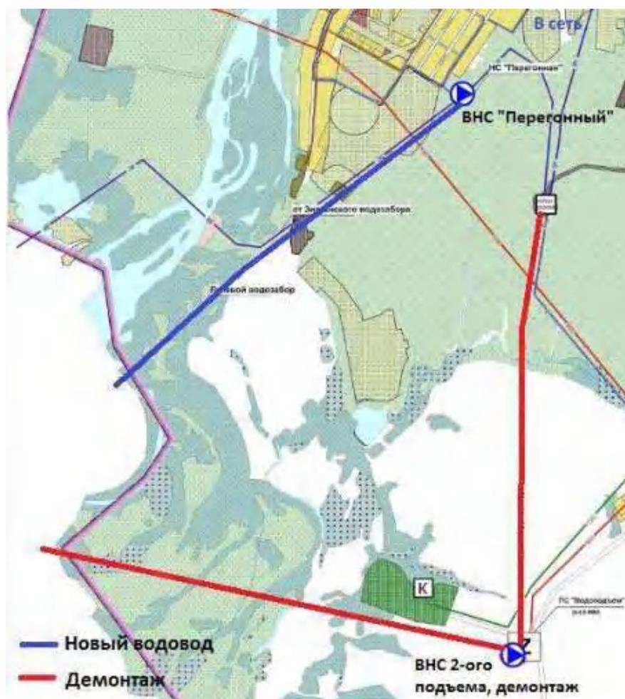
Рисунок 1.4.2.4 – Схема прокладки нового водовода от водозабора до насосной станции Перегонный
