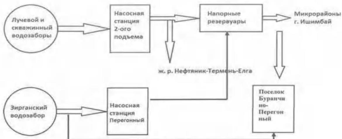
**Рисунок 1.1.1.1 – Общая схема подачи воды потребителям г. Ишимбай**
