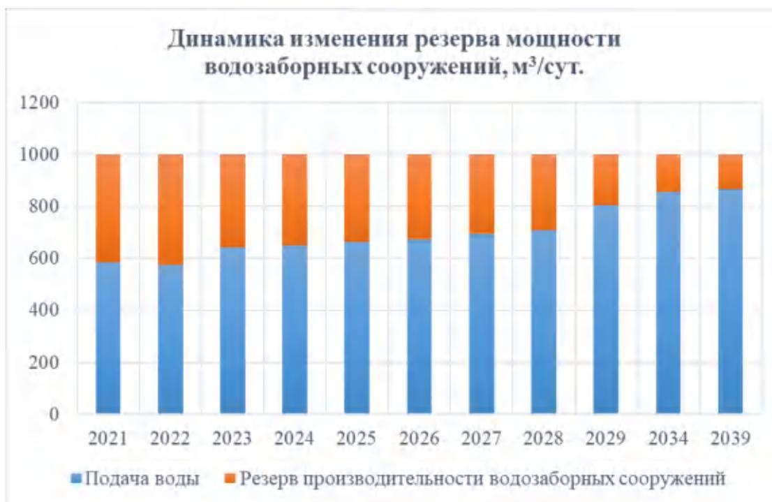
Рисунок 1.3.14.1 – Динамика изменения резерва мощности водозаборных сооружений
